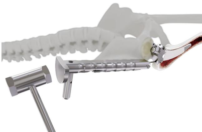
**Abb. 9 ▲** Mit vorsichtigen Hammerschlägen Einschlagen des Meißels. Über den Ausschlag-Pin, welcher optional am Einschlaginstrumentarium befestigt wird, kann bei Auftreten eines Widerstandes ein Zurückschlagen des Meißels erfolgen, um in kleinen Schritten den Meißel schrittweise im Knochen zu versenken. (Mit freundl. Genehmigung der Mathys AG Bettlach)
